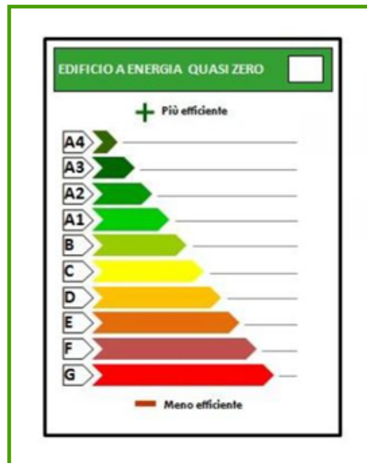
Figura 26: Scala di prestazioni energetiche per la classificazione degli edifici in Italia (dalle Linee Guida Nazionali per le Certificazioni Energetiche degli edifici, Allegato I)
